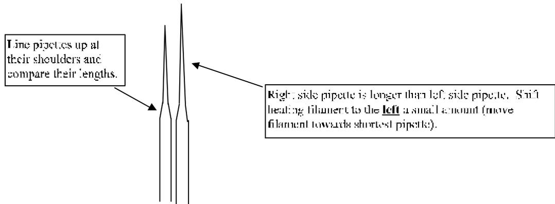
**Figure 25. Micropipette Shapes**
