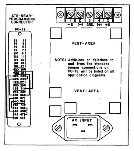
FIG. 3-2 STANDARD JUMPER LINK CONNECTIONS FOR LOCAL (FRONT PANEL)
