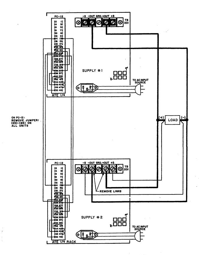
FIG. 3-25 CONNECTIONS FOR AUTOMATIC PARALLEL OPERATION.
