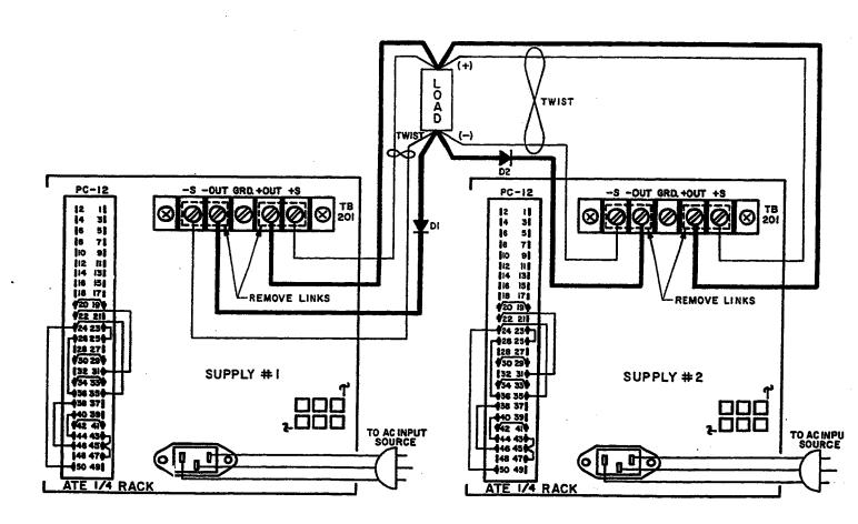
FIG. 3-28 REDUNDANT PARALLEL CONNECTION WITH ATE POWER SUPPLIES.
